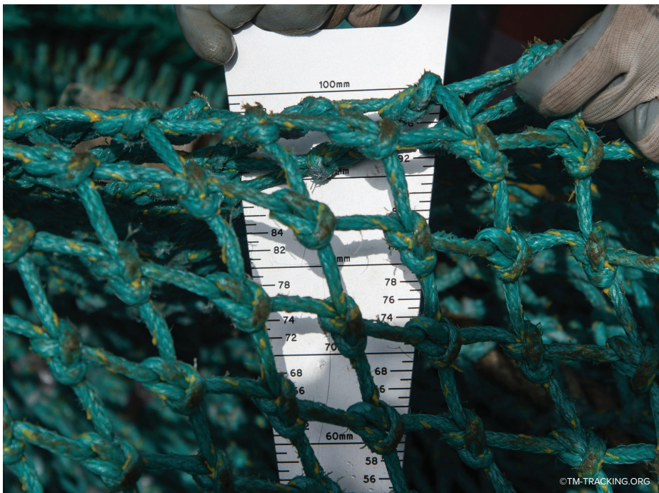
El tamaño de la malla puede medirse usando una herramienta especial llamada un medidor de red ©TMT
