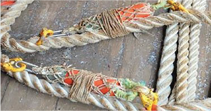
Dispositivo Disuasorio de Delfines (DDD) atado a la red
